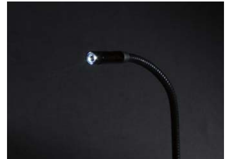
曲げ伸ばし自在なチューブは、好みの角度に固定することも可能。直径10mmのカメラヘッドは、狭いすき間でも簡単に進入。照明用に白色LEDも搭載している
